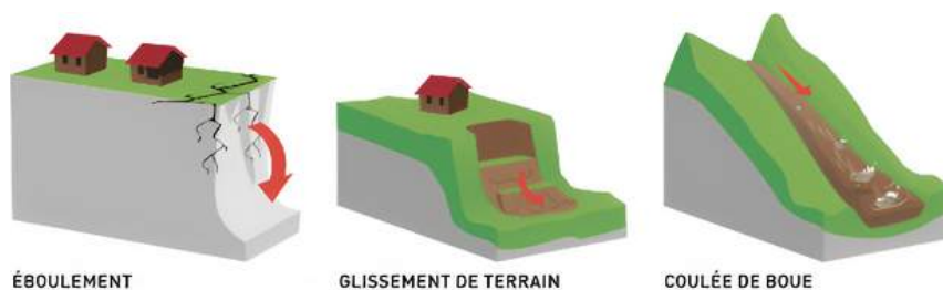
Schéma des trois types principaux de mouvements de terrain à Mayotte. Source : Croix-Rouge française (2021).
